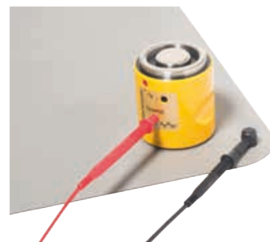
Пример использования: измерение цилиндрическим электродом
