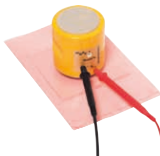
Пример использования: измерение концентрическим кольцевым электродом
