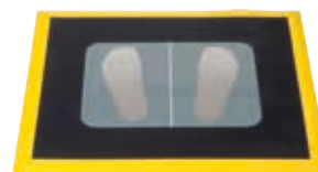
Напольный коврик электрода для тестирования обуви Размеры: 830 x 680 x 13 мм Поставляется без ногого электрода
